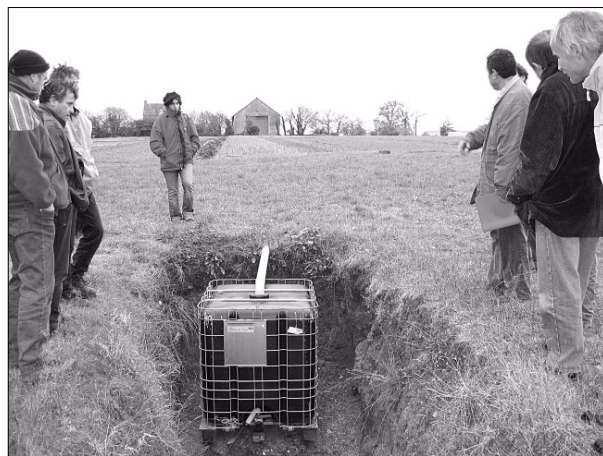
Le dispositif de captages des pesticides de Kerguéhennec. Il a permis de mettre en évidence la nette augmentation des fuites de pesticides par ruissellement avec les TSL, en période hivernale, à même dose apportée et sur des parcelles en pente moyenne.
