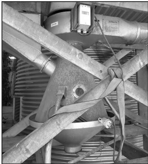
Pré-nettoyeur de type Cyclone de Pierre Queniat
