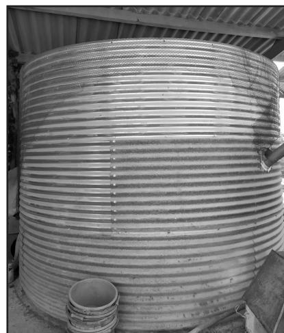
Le silo cylindrique en métal est le stockage qui demande le moins de place et qui refroidit le plus vite.
