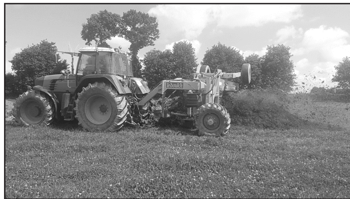
Retournement d'un tas de fumier Source : CUMA Bretagne Ille Armor
